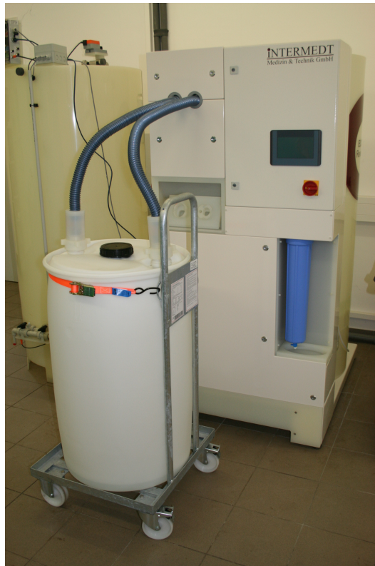
2.1. ábra. ECOMix Revolution gyártási rendszer sópatronnal ( ECOCart )
