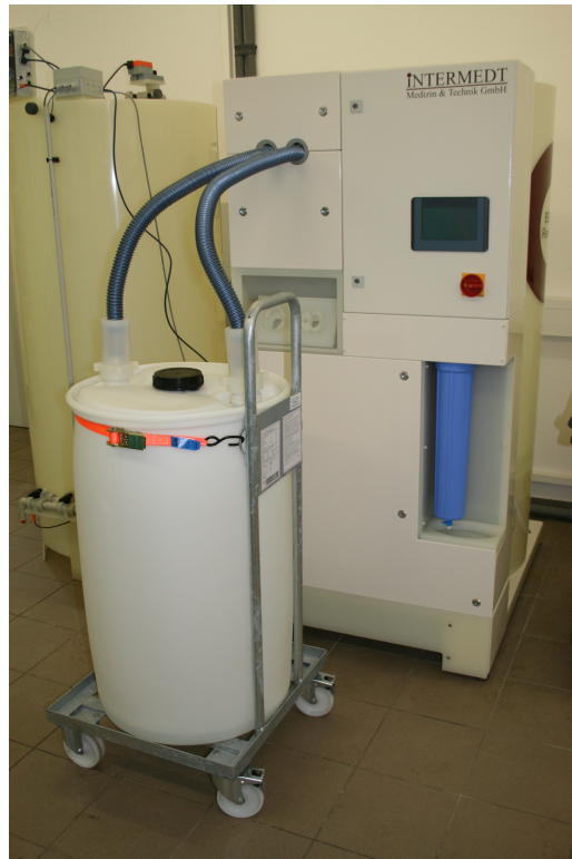
图 1: 带有盐桥 ( ECOCart ) 的 ECOMix Revolution 生产系统
